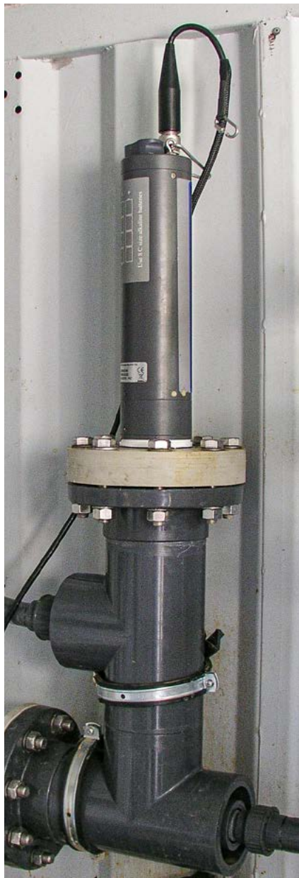
Multiparametrická sonda YSI 6006 na přítoku do nádrže
