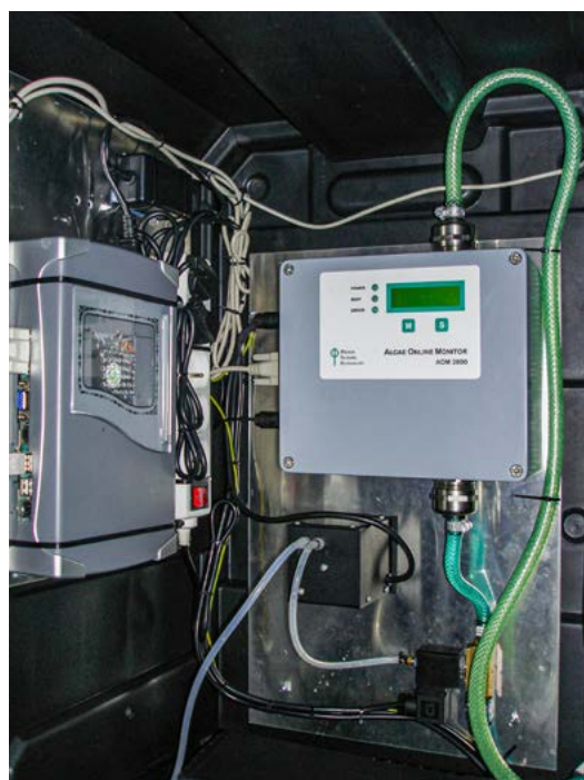
Stanice pro monitoring fyziologického stavu buněk biomasy AOM (Algal Online Monitoring)
